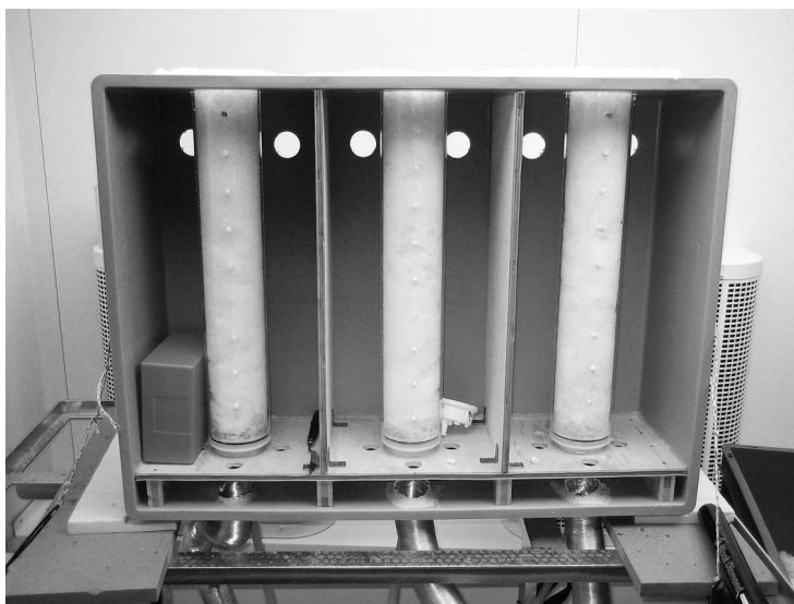
FIG. 2.10 – Dispositif expérimental pour l'observation de la mobilité des algues de neige dans des colonnes de neige sous conditions contrôlées. Pendant l'expérience, le dispositif expérimental est fermé sur le côté à l'aide d'un couvercle de sorte que la lumière ne pénètre que par le haut des colonnes.
