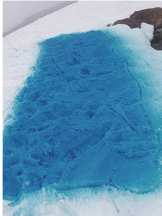
FIG. 2.4 – Répartition de 2 \text{ l/m}^2 de Brilliant Blue ( 2 \text{ g/l} ) sur une surface 1 \times 4 \text{ m} lors de l'essai de traçage pour mettre en évidence l'écoulement de l'eau dans le manteau neigeux.
