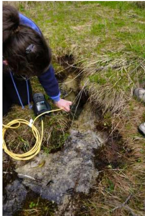
**Figura 13:** misura della temperatura e della conduttività elettrica in una sorgente della Val Piora.
